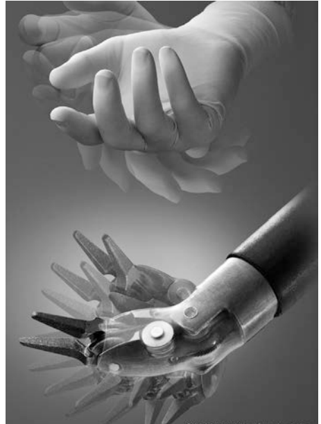
De da Vinci operatierobot 'vertaalt' de grote bewegingen van de uroloog in heel fijne, nauwkeurige bewegingen van de instrumentjes
